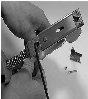
Die Nullstellung des Schiebers leicht nachstellen und erneut eine Kontrolle vornehmen (vorheriger Arbeitsgang).
