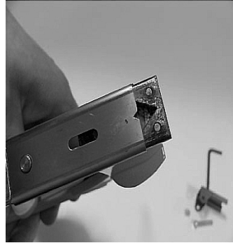
3 - Vor dem Heften die Schließkappe ganz herunterdrücken, um die äußere Spitze des Schieberwegs für den Durchgang der Klammern zu beobachten.
