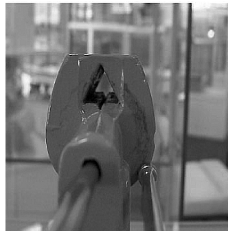
3b - Kontrolle: Beispiel - der Schieber ist weit genug geöffnet : die Klammern können nach unten gestoßen, um losgehakt und durch den Schieber eingedrückt zu werden.
